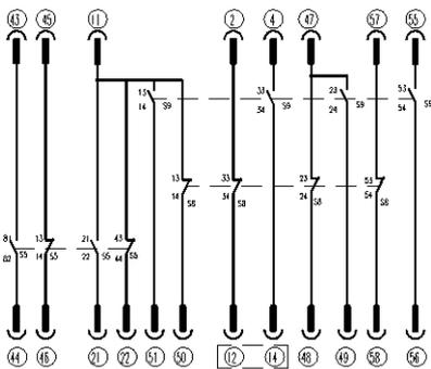
注1：当无合闸闭锁BC时，虚框中的S8、S9的接点并接后串入合闸回路10-20（见L处）；
