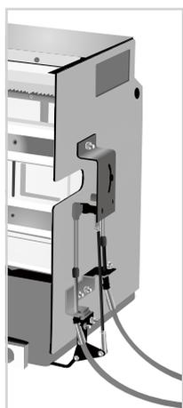
此装置分两部分，安装在固定式断路器和抽出式断路器侧面的机构，此部分只能在工厂预先安装。可现场安装的柔性钢缆，提供1.0、1.6、2.0、3.0、3.5米不同的长度供客户选择。
