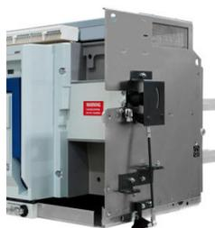
此设备可让2至3台并列或上下安装的ME09低压空气断路器直接联锁，无论它是固定式还是抽出式。联锁机构由特殊设计的钢丝绳连接以适应不同额定电流规格。钢丝绳的长度从1至3.0m。
