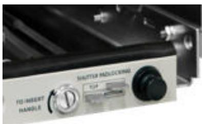
此装置只适用于抽出式断路器，这个系统通过钥匙将断路器锁定在断开位置。当钥匙取下时，安全挡板位置自动锁定，阻止断路器进入主电路投入运行。
