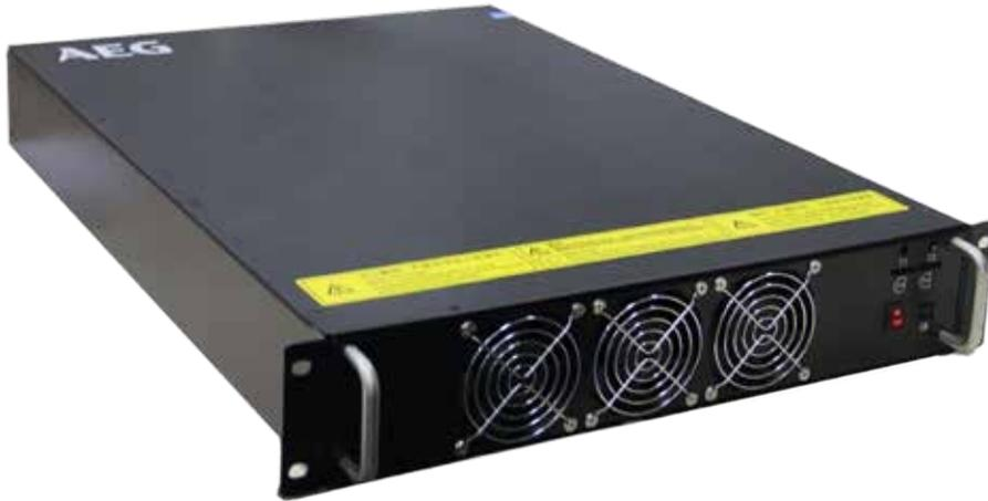
AEG新一代无功补偿装置ALPS ASC系列采用可关断电力电子器件(IGBT)组成自换相桥式电路, 经过电抗器并联在电网上, 适当地调节桥式电路交流侧输出电压的幅值和相位。迅速吸收或者发出所需的无功功率, 实现快速动态调节无功的目的。作为有源型补偿装置, 不仅可以跟踪冲击型负载的冲击电流, 而且可以对谐波电流也进行跟踪补偿。
