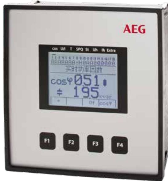
PFC系列功率因数控制器采用64位微处理器通过 A/D 互感器来测量电力系统电压和电流，计算系统有功功率和无功功率等参数。根据设定的目标功率因数实时计算欠补偿或过补偿功率，自主选择具备适当补偿容量的投切步级，自动投切，对电网无功实时优化。
