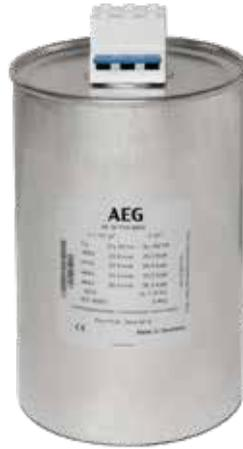
AEG电力电容器采用镀特殊金属成份的聚丙烯膜MKPh绕制而成，由于创新的金属化处理，聚丙烯膜在卷绕期间承受较少的应力，使得电容器具有达到2In的过载能力及更有效的自愈性和低的介质损耗，并且运行温度大大降低。利用封闭性和工艺的改进使电容器既能获得与油式电容器一样优越的电压电流性能，同时明显地减少了体积。将每个电容器单元装在壳内并应用树脂介质技术极大的保证了电容器的散热性和接地绝缘，提高了电容器的寿命。外壳应用特殊的双重卷边工艺组装以及新型密封剂的应用以保证完美的密封性，过压力保护使系统安全运行。广泛应用于无功补偿及滤除谐波的场所。
