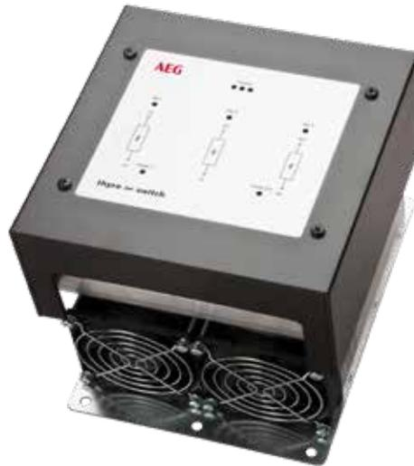
工业中存在许多负载变化快速且频繁的设备，这时使用交流接触器无法满足系统无功补偿的即时投切需求，可采用具有“过零投切”操作的可控硅投切开关，来实现极其快速的投切和无电弧、浪涌电流的切离操作。EFC/CLC系列可控硅投切开关通过快速的电子式控制，能自适应电容器负载，动态响应时间在毫秒，能够快速的改善电网的功率因数，适用于无功快速、频繁变化和限制涌流、电压波动的场合。
