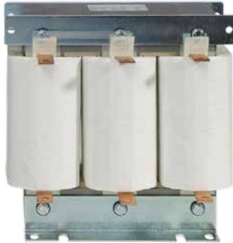
当系统中有谐波的存在，在电容器上增加负荷反映为对电流更高的损耗，更高的电流损耗意味着热过载，致使电容的寿命缩短。在并联电容器的回路中串联滤波电抗器是非常有效和可行的方法。串联滤波电抗器的主要作用是抑制高次谐波和限制合闸涌流，防止谐波对电容器造成危害，避免电容器装置的接入对电网谐波的过度放大和谐振发生。
