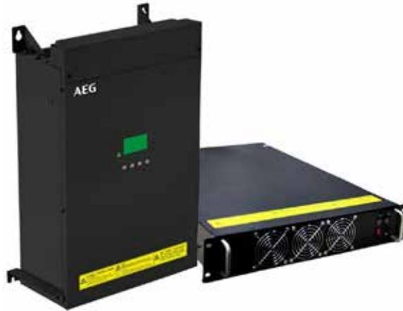
ASW系列有源电力滤波器，采用新一代64位微处理器、三电平结构主电路，控制快速，高效率、低功耗，有利于暂态稳定性的提高。ASW实时检测非线性负载产生的电流波形，分离出谐波部分，再通过IGBT逆变电路输出等同的谐波电流，以抵消负载谐波，确保从电网吸取的电流为正弦波，实现谐波滤除功能。此外，ASW还能提供超前或滞后的无功电流，用于改善电网的功率因数，实现动态无功补偿。
