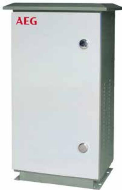
ASP系列三相不平衡智能调节器是一种用于动态治理电网三相不平衡、补偿无功的新型电力电子装置，它能够根据电网用户由于不同时间段或不同负荷导致的电网三相不平衡电流，利用先进控制算法分离出不平衡电流的正负零序及无功，通过触发功率器件 IGBT，使逆变器发出与之相反的抵消电流，达到消除不平衡及补偿无功的作用。可广泛应用于电力配网系统中（如台网/农网）、特殊用户侧户外供电系统（如油田的磕头机、野外移动供电设施等）。
