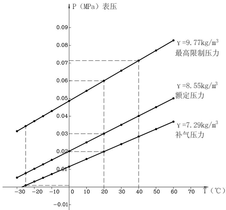
图 11 压力随气体密度、温度变化曲线
