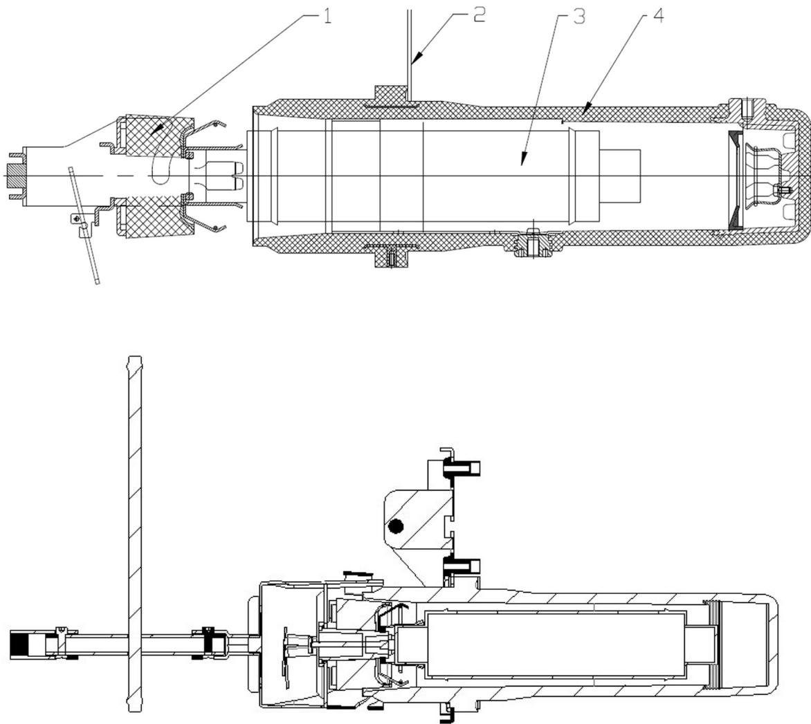
1.熔断器夹头 2.密封箱体 3.熔断器 4.熔断器筒
