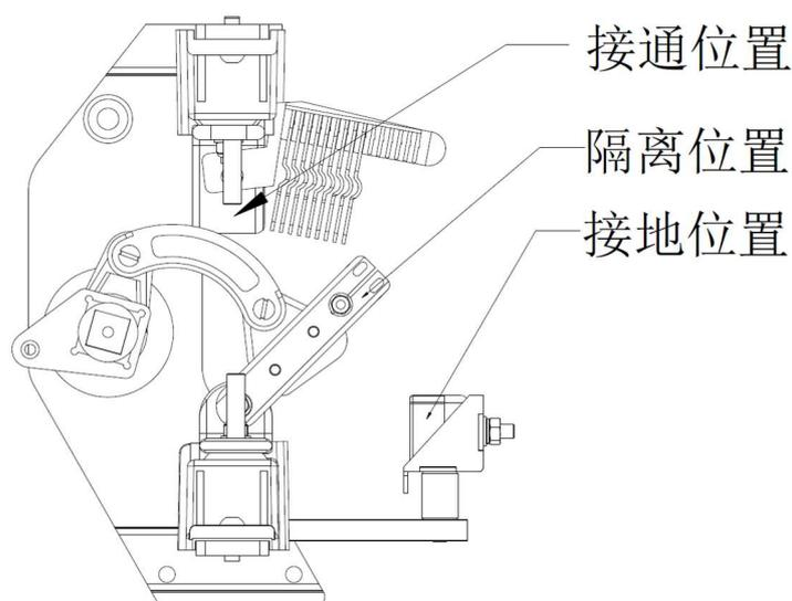
图 8 三工位隔离开关
