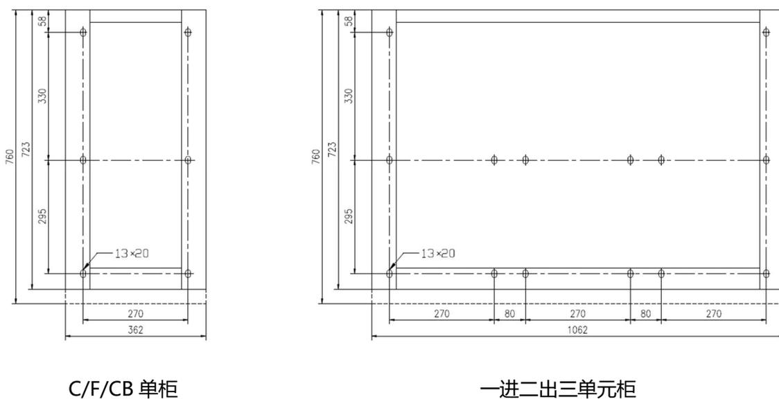
图 9 环网柜安装基础尺寸
