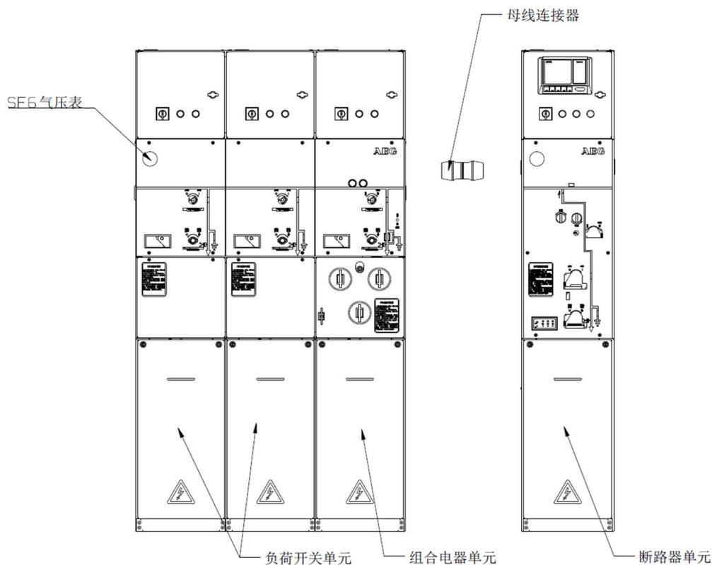
图 4 环网柜结构简图
